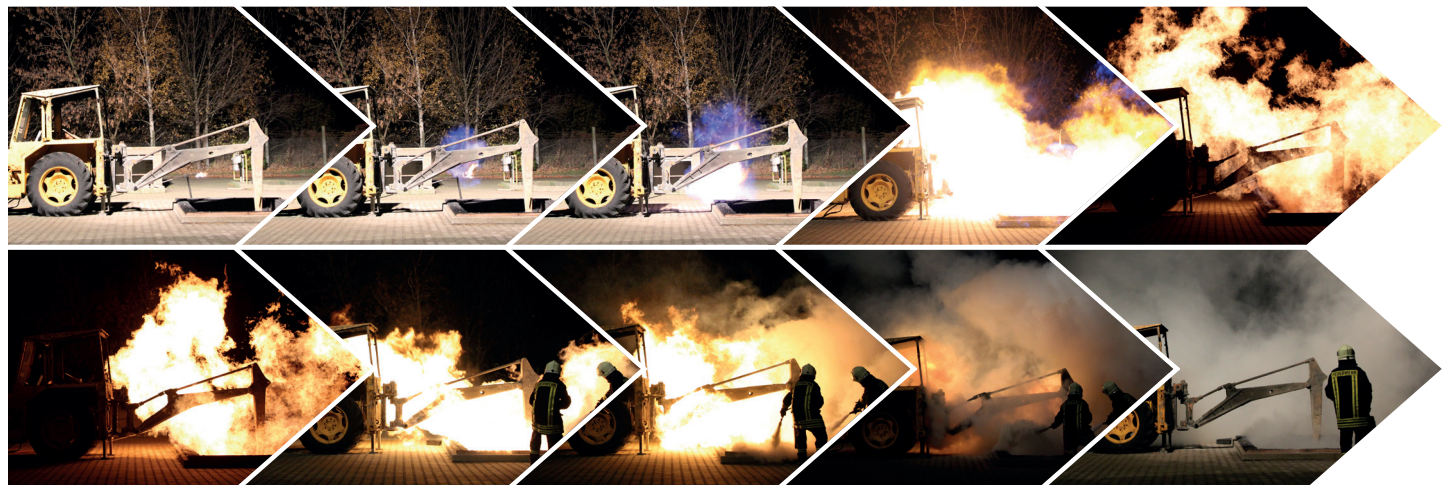
Löschen eines durch den Bagger verursachten Gasbrandes
