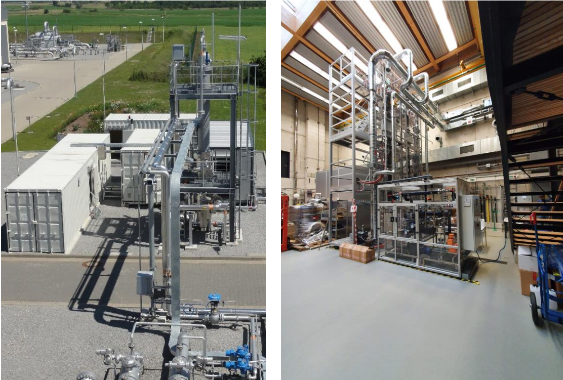
Abbildung 1: Links: Pilotanlage zur Entwässerung von TEG aus der Erdgastrocknung mit eigenem Absorber und vier Anlagencontainern. Rechts: Laboranlage (rechts unten) nach Integration in eine OME-Pilotanlage für die Entwässerung eines OME/MeOH/Formaldehyd-haltigen Zwischenproduktstromes (Standort bei Projektpartner).
