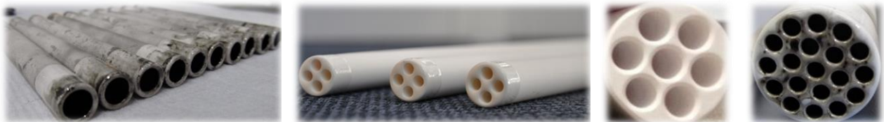
Abbildung 2: Bilder ausgewählter Membrantypen und -geometrien. Von links nach rechts: 250 mm Einkanalmembran, 1200 mm Vierkanalmembran (in Pilotanlage im Einsatz), 1200 mm Sieben- und 19-Kanalmembran
