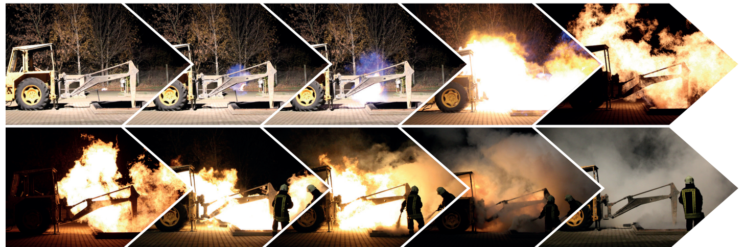
Löschen eines durch den Bagger verursachten Gasbrandes
