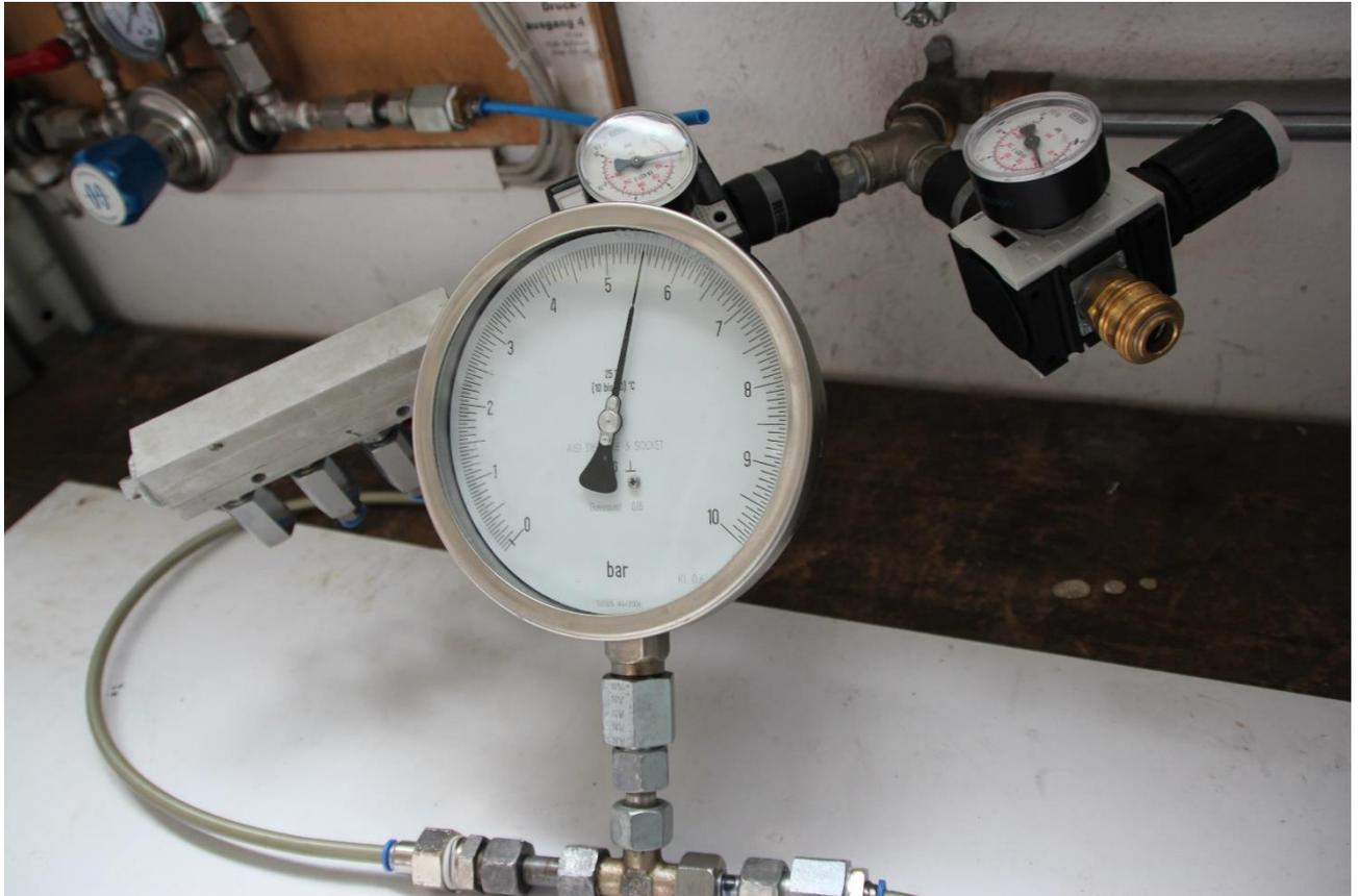
**Abbildung 1: Dichtheitsprüfung 5,5 bar(a) Prüfdruck**
