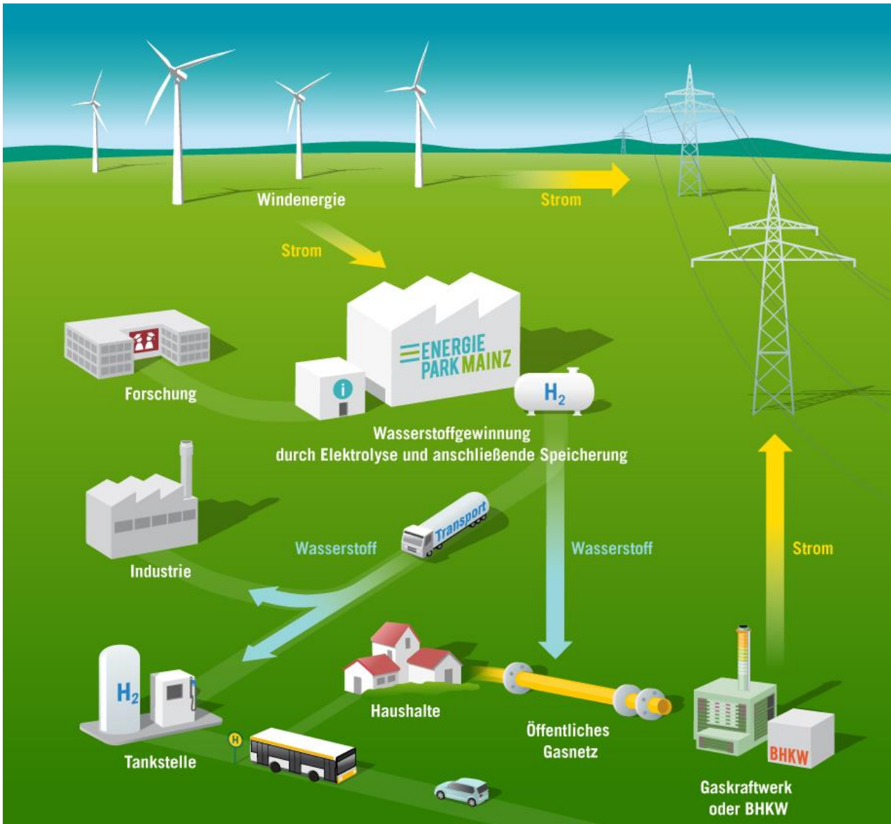
Abbildung 13: Kreislauf des Energieparks Mainz (Bildquelle: Mainzer Stadtwerke AG) [31]
