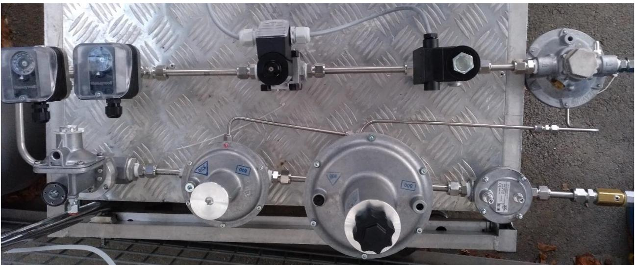
**Abbildung 9: Getestete Gas-Druckregelstrecke, Versuchsaufbau**
