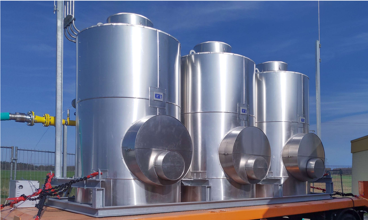
Abbildung 3 Adsorbereinheit, ca. 16 bar, mobil (Quelle DBI)
