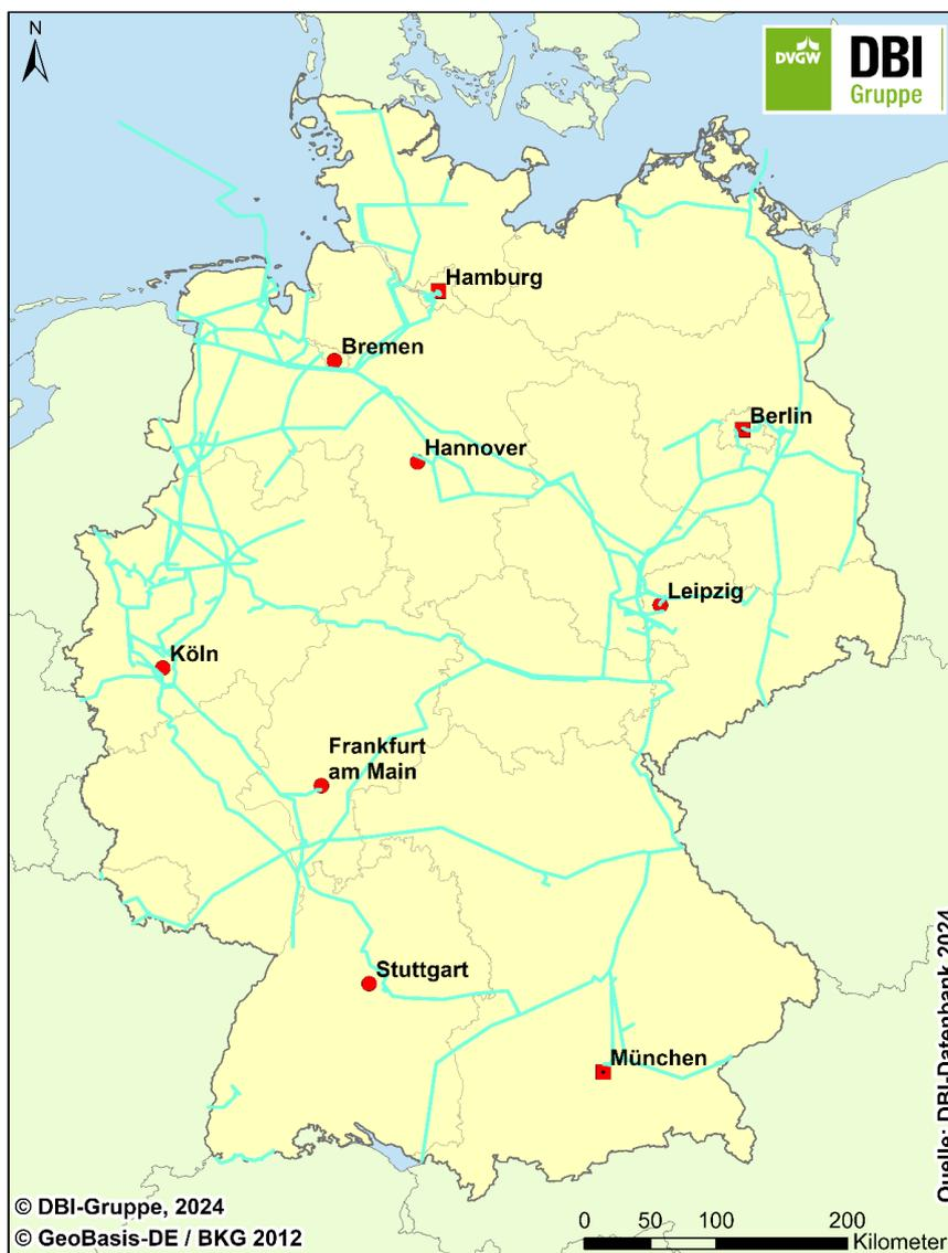
Abbildung 3: Verlauf des H<sub>2</sub>-Kernnetzes zum Planungsstand Juli 2024 (Quelle FNB [17])
