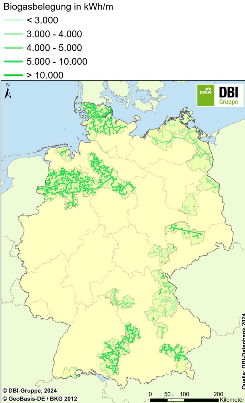
Abbildung 16: Netzverlauf modellierter Biogasnetze in Mischgebieten für Szenario 1 (Biogasbelegung > 2.000 kWh/m)
