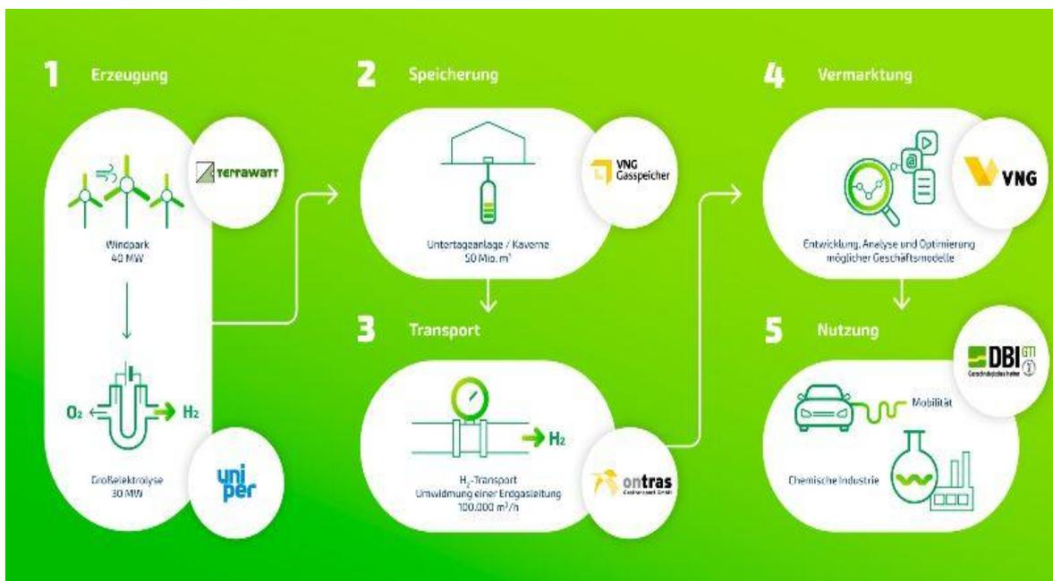
Bild: Mittels Power-to-Gas-Technologie verbindet das großtechnische Reallabor intelligent die Erzeugung von grünem Wasserstoff aus Windstrom mit der anschließenden Speicherung, dem Transport sowie der Vermarktung und dessen Nutzung. (Quelle: <https://www.energiesystemforschung.de/forschen/projekte/energiepark-bad-lauchstaedt>)
