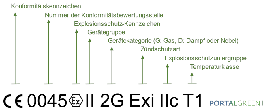
Abb. 7.3 Kennzeichnung, die an einem Gerät zum Gebrauch in explosionsgefährdeten Bereichen anzubringen ist
