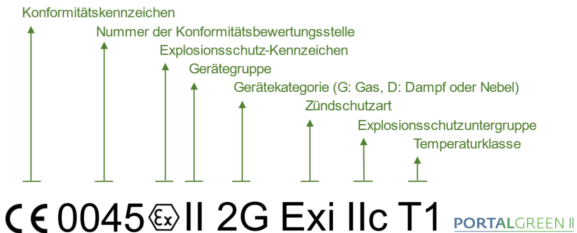
Abb. 5.5 Kennzeichnung, die an einem Gerät zum Gebrauch in explosionsgefährdeten Bereichen anzubringen ist
