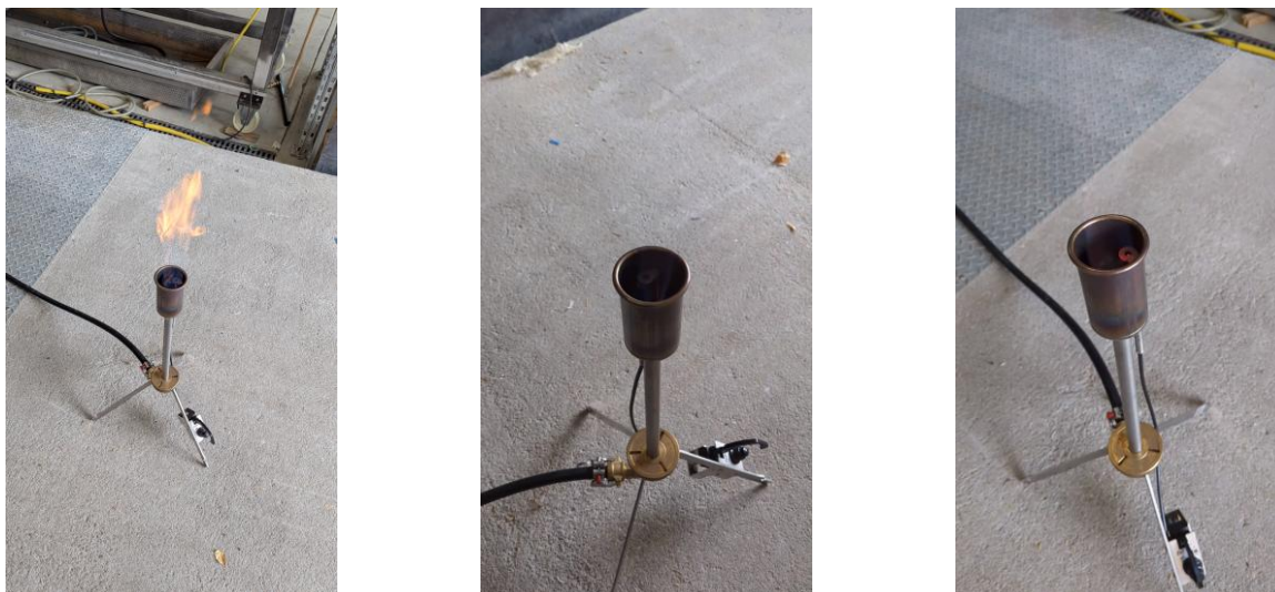
Abbildung 10: Fackel an ausgewählten Versuchspunkten mit unterschiedlicher Gaszusammensetzung (links: 83 % \text{CH}_4 + 13 % \text{H}_2 + 3 % \text{N}_2 ; mittig: 18 % \text{CH}_4 + 71 % \text{H}_2 + 10 % \text{N}_2 ; rechts: 1,7 % \text{CH}_4 + 98,3 % \text{H}_2 )
