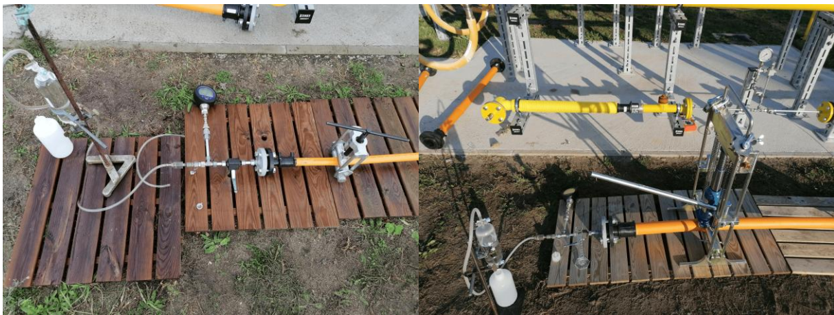
Abbildung 45: Versuchsaufbau am DN25 und DN50 Prüfling mit der manuellen und hydraulischen Quetsche
