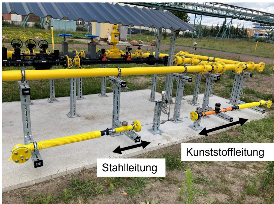
Abbildung 38: Versuchsstand zum Schleusensperrverfahren und Komponentenversuchsstand
